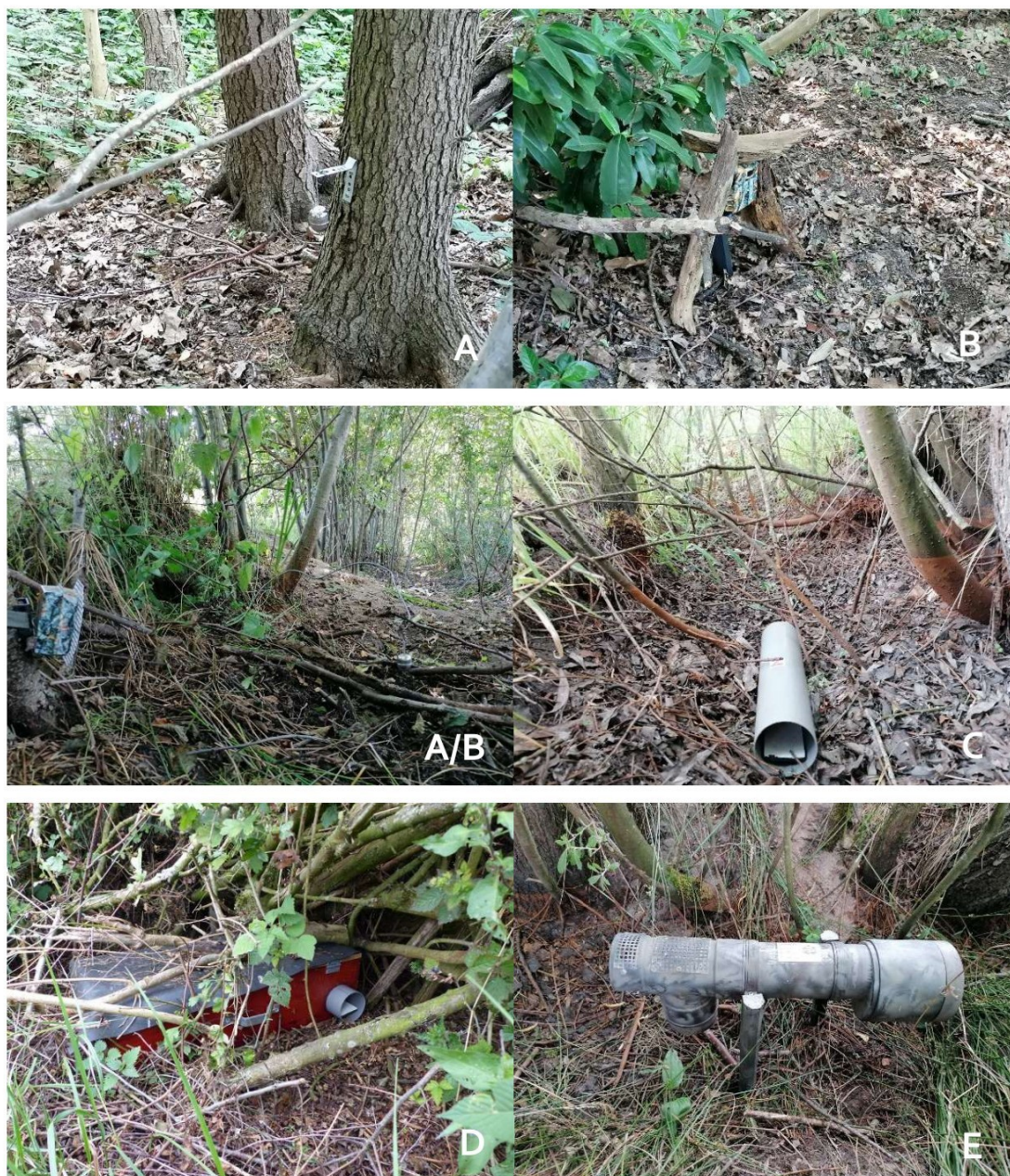
Afbeelding 3.16 Onderzoekstechnieken: Losse cameraopstelling (A) ,Jiggler' (B), Sporenbuis (C), 'Mostela' (D) en tubecam (E) (©MOS-Ecologie).
